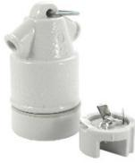
Fassung E27 Feucht zum Hängen, 3-teilig mit Schraubring und Aufhängebügel, Kappe, Mantel und Einsatz aus Porzellan, Anschluss bis 2.5mm<sup>2</sup>, Zündspannungsfestigkeit 5kV, maximaler Strom 4A, wärmebeständig bis T220°
