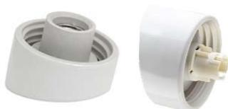
Wandarmatur, 2-teilig, aus Porzellan, E27 mit Fassung aus Porzellan, B22 mit Fassung aus Kunststoff, LED ohne Einsatz (Einsätze siehe unten\*), Befestigung durch 2 Langlöcher mit einer Distanz von 60-66mm oder mit 2 versteckten Löchern mit einer Distanz von 70mm, 2 ausbrechbare Kabeleinführungen, Schutzglasgewinde 84,5 mm, **IP20** Klasse II, max. 75W, inkl. Dichtungsring für Einsatz und Glas
