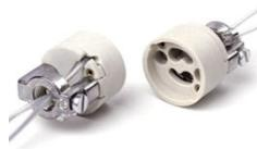
Fassung GU10 aus Steatit, mit Erde, für Lampen mit Aluminium-Reflektor, doppelt isoliert, 250V, 2A, T250°, IP20, mit FEP-Litzen 250mm, Befestigung: verzinkter Befestigungssockel mit M10x1 und Erdschraube
