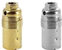
Fassung E14 aus Stahl vermessingt oder verzinkt, mit Porzellan-Einsatz und Erde, Mantel glatt, Anschluss bis 2.5mm<sup>2</sup>, 3-teilig, 250V, 2A
