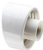
Feucht-Wandarmatur, 2-teilig, aus Porzellan, E27 mit Fassung aus Porzellan, B22 mit Fassung aus Kunststoff, LED ohne Einsatz (Einsätze siehe unten\*), Befestigung durch 2 Langlöcher mit einer Distanz von 60-66mm oder mit 2 versteckten Löchern mit einer Distanz von 70mm, eine ausbrechbare Kabeleinführung, Schutzglasgewinde 84,5 mm, **IP54** Klasse II, max. 75W, inkl. Dichtungsring für Einsatz und Glas
