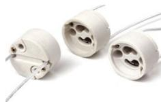
Fassung GU10 aus Steatit, für Lampen mit Aluminium-Reflektor, doppelt isoliert, 250V, 2A, T250°, IP20, mit FEP-Litzen, 250mm
