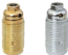
Fassung E14 aus Stahl vermessingt oder verzinkt, mit Porzellan-Einsatz und Erde, Mantel mit Aussengewinde, Anschluss bis 2.5mm<sup>2</sup> 3-teilig, 250V, 2A
