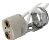
Fassung für Kombi-Anschluss, 8A, 230V, T250° G4 - Gy6,35 m. Silikonlitzen 250 / 0.75mm<sup>2</sup>, federnde Reinnickel-Kontakte, mit Befestigungsrippe M10x1
