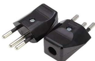
Stecker Typ 12 aus Thermoplast, teilisoliert; Anschluss zum Schrauben, mit Zugentlastung, 10A; 250V
