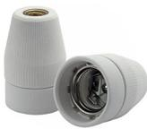
Fassung B22d 3-teilig mit Schraubring und Gewindenippel, Kappe, Mantel und Einsatz aus Porzellan, Anschluss bis 2.5mm<sup>2</sup>, Zündspannungsfestigkeit 5kV, maximaler Strom 4A, wärmebeständig bis T220°
