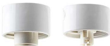
Feucht-Deckenarmatur, 2-teilig, aus Porzellan, E27 mit Fassung aus Porzellan, B22 mit Fassung aus Kunststoff, LED ohne Einsatz (Einsätze Seite 5.1.30), Befestigung durch 2 Langlöcher mit einer Distanz von 60-66mm oder mit 2 versteckten Löcher mit einer Distanz von 70mm, 1 ausbrechbare Kabeleinführungen, Schutzglasgewinde 84,5 mm, **IP54** Klasse II, max. 75W, inkl. Dichtungsring für Einsatz und Glas
