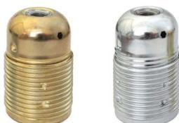
Fassung E27 aus Stahl vermessingt oder verzinkt, mit Porzellan-Einsatz und Erde, Mantel mit Aussengewinde, Anschluss bis 2.5mm<sup>2</sup>
