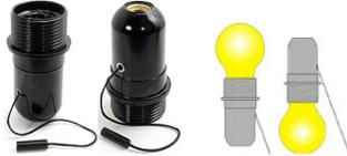
Zugschalter Fassung E27 hängend/stehend, komplett mit Nippelgewinde M10x1, aus Duroplast mit Aussengewinde und Halterand und Kontakten aus Messing
