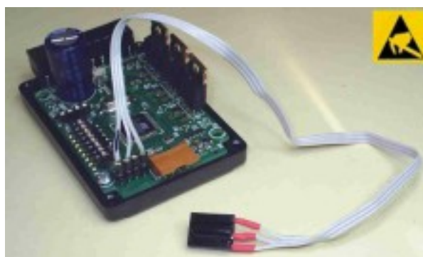
Modul mit verlängertem Kabel (ca. 20 cm, ohne Schirm)
